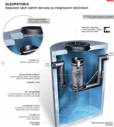
Slika 3: konstrukcija separatora u preseku
