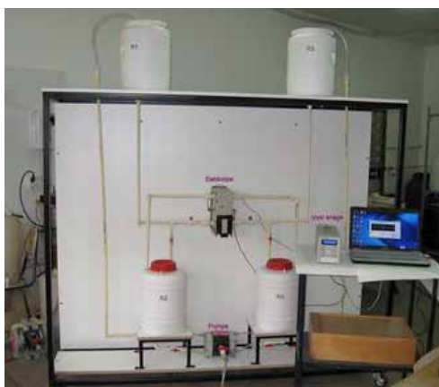
Slika 1 Laboratorijski protočni reaktor za elektrohemijom sintezu ferata(VI)
