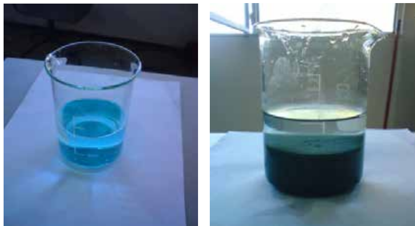
Slika 3 Otpadna voda iz pogona za rafinaciju bakra pre i posle tretmana feratom(VI)
