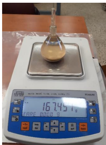
Slika 7.2.3.1. Merenje piknometra na elektronskoj vagi
