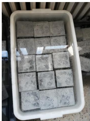
Slika 8.1.2.1. Negovanje uzoraka betonskih kocki
