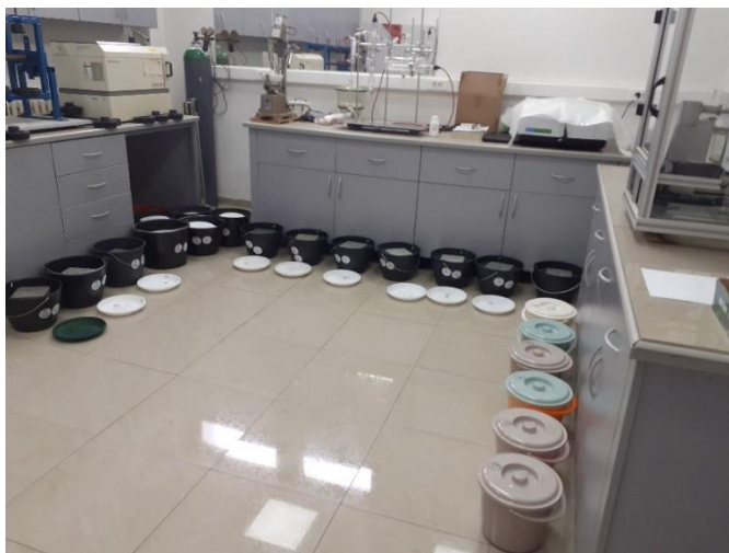
Slika 10.1.1. Postavljeni uzorci za NEN metodu.
